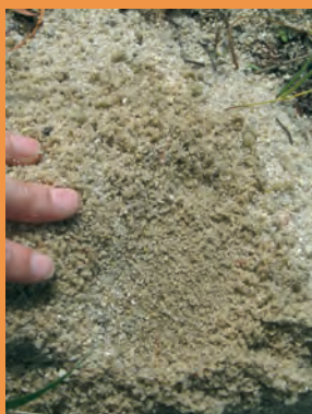
Fig. 34. Material triturado extraído cada metro durante el avance de la perforación.
