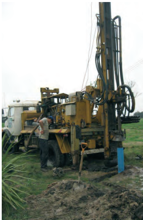
Fig. 17. Máquina perforadora. Método de rotopercusión
