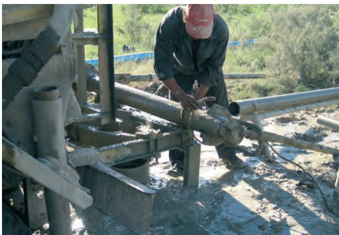
Fig. 17. Máquina perforadora. Método de rotopercusión
