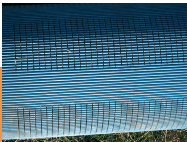
Fig. 26. Filtro de PVC. Largos de 2 y 4 m. Ranuras de 0.5 y 0.75 mm. Clase liviana, estándar y reforzada.
