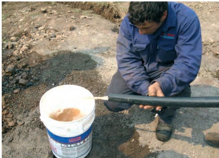
Fig. 32. Medición de caudal o aforo
