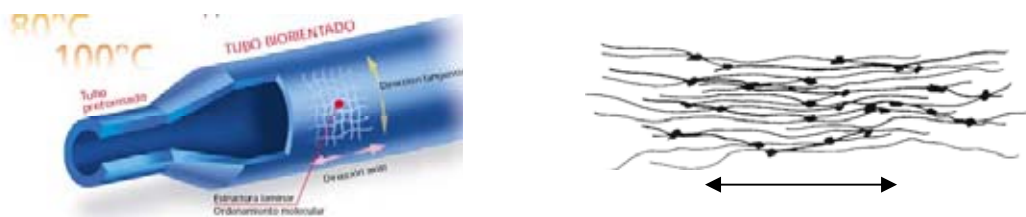
Fig. 109 Orientación molecular tubos PVC-O
