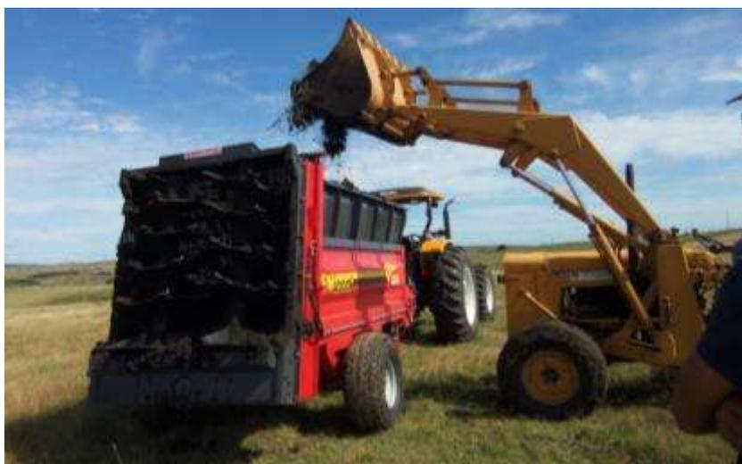
*Figuras 3. Carga de estiercolera de sólidos para distribución del lodo deshidratado.*
